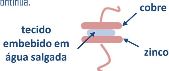
Cada elemento de pilha é constituído por dois discos metálicos, um de cobre e outro de zinco, separados por tecido embebido em água salgada.
