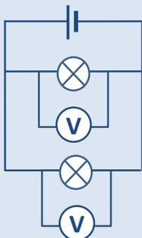
Cada voltímetro regista a tensão fornecida pela pilha.
